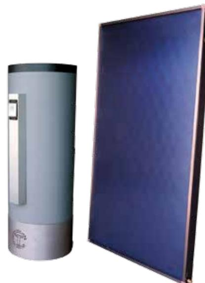
La familia de sistemas forzados Termidrain de Termicol basa su funcionamiento en el drenaje del circuito primario (sistema drain-back) de los paneles solares para evitar el sobrecalentamiento de los captadores del sistema, así como su posible congelación por bajas temperaturas en la época invernal.
